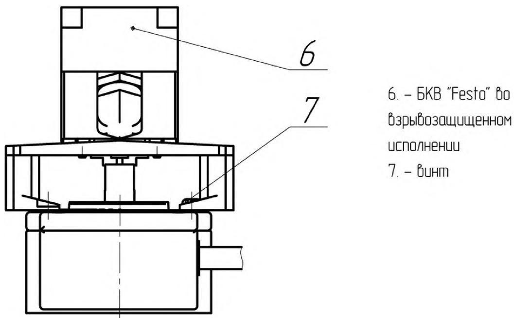
Рис.5а. Редуктор с БКВ «Festo» во взрывозащищенном исполнении.
