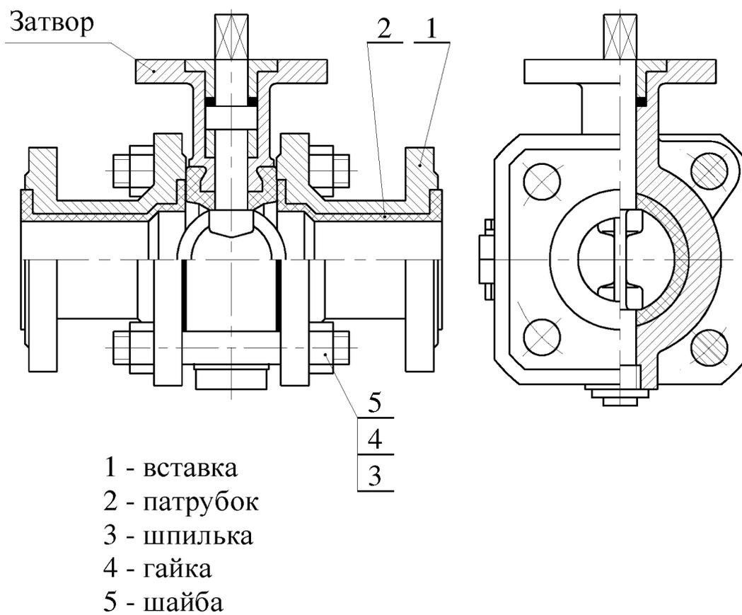
Рис. 12. Затвор DN 32-40 без органов управления.
