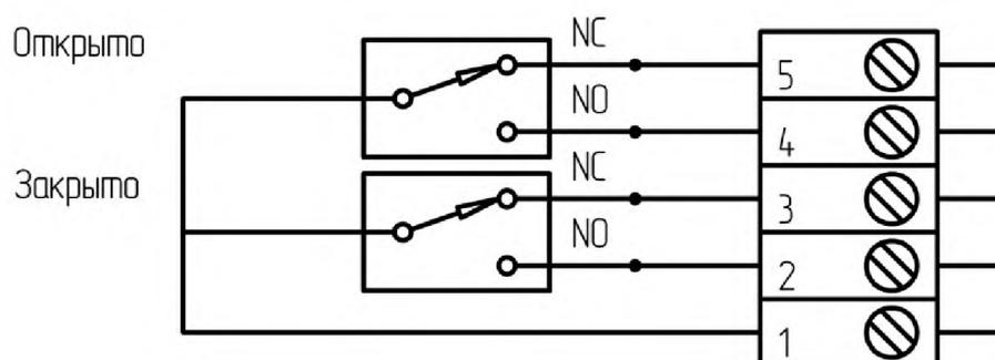
Рис. 8б. Блок концевых выключателей «Festo» во взрывозащищенном исполнении.
