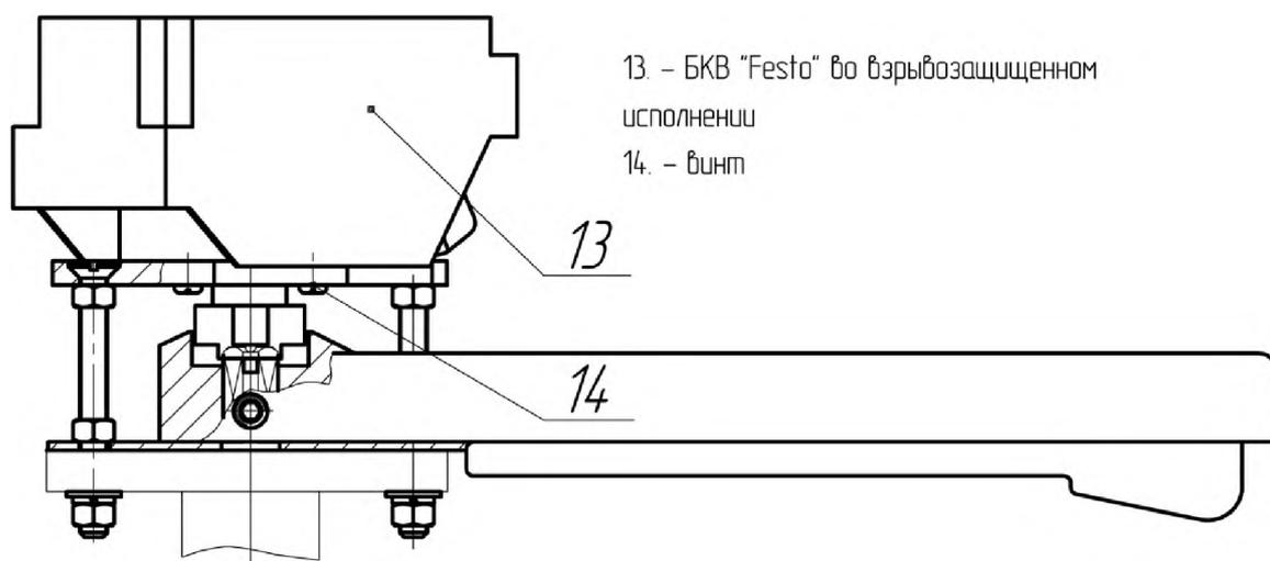
Рис.3а. Установка БКВ «Festo» во взрывозащищенном исполнении на рукоятку.
